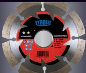
El disco posee segmentos de forma rectangular, es utilizado en corte de materiales relativamente blandos y abrasivos. Su diseño permite una descarga del material removido más ágil, impidiendo que el mismo trabaje sobre los flancos de la liga diamantada, extendiendo su vida útil. Se recomienda para baldosones, mamposterías, cerámicas blandas, contrapisos y carpetas de cemento, fibra de vidrio, hormigón fresco, ladrillos cerámicos, lajas, etc.
